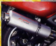
↑最高出力は後輪でノーマル比8.4psアップの36.7ps。実用速度域に谷があるノーマルに対し、TMAX-Rはその付近で大幅にパワーアップを達成。
